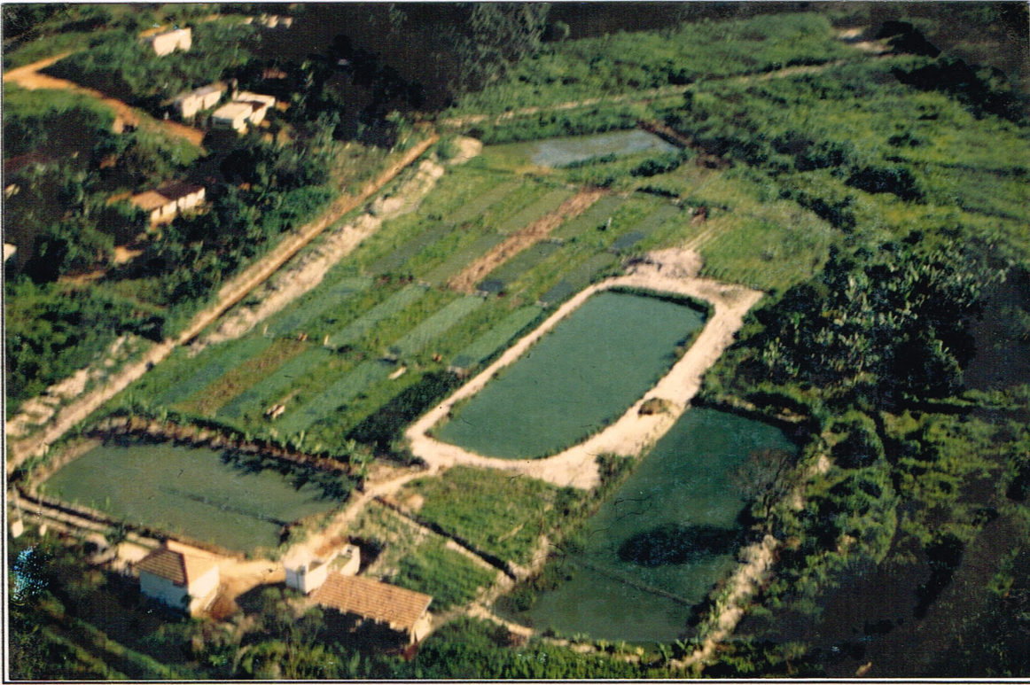
Prefeitura de Silva Jardim – Lagoas de Oxidação, Tanques de Macrófitas (Lemna) e diques cultivados da estação Silva Jardim Municipality – The Oxidation and Macrophyte Ponds (Lemna); the garden areas of the Station
